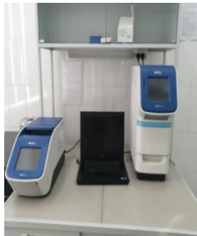
ПЦР амплификаторы: классический и в реальном времени, генетический анализатор (секвенатор)
